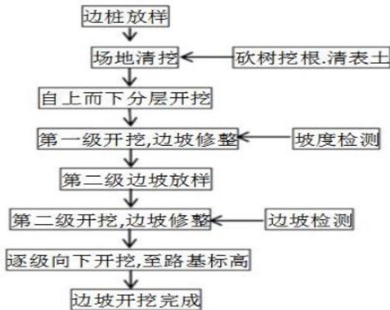
图 2.9.1-2 路基边坡施工工艺流程
