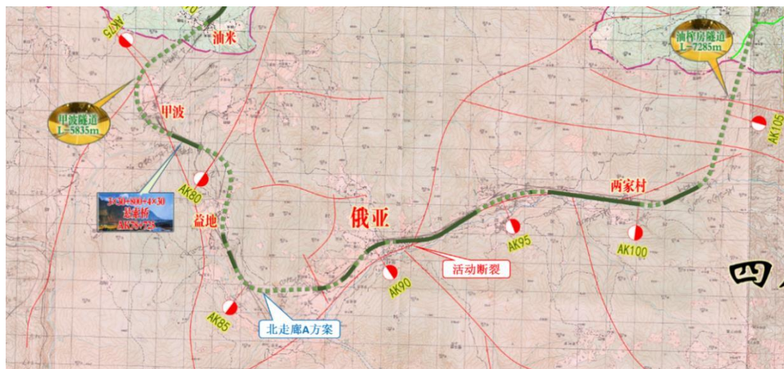
图 8.1.3-2 北走廊 AK75+000-AK102+500 路段与活动断裂位置关系示意图
